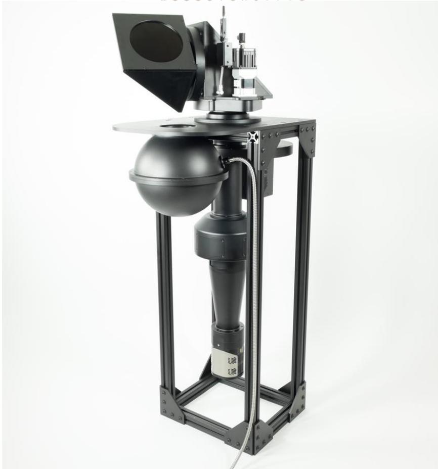
Интерферометр Фабри-Перо КЕО Scientific “Arinae” (ИФП) расположен в геофизической обсерватории ИСЗФ СО РАН вблизи п. Торы (Россия, Бурятия). Принцип определения температуры основан на регистрации величины доплеровского уширения линии естественного ночного свечения атмосферы 557.7 нм, излучаемой атомарным кислородом в слое толщиной около 10 км, находящемся на высоте 90-100 км над поверхностью Земли а так же расчет ветра на основе доплеровского смещения.
